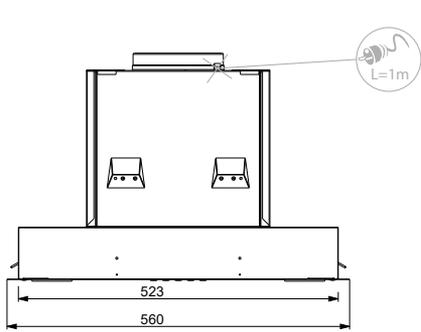
Modèle avec moteur 560 mm
